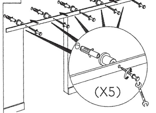
**2B** Para instalación con soporte en paredes de yeso
