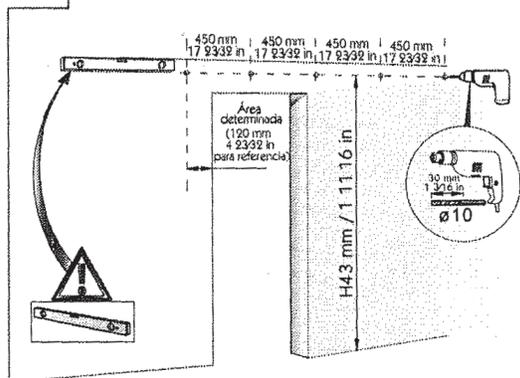
**1B** Para instalación con soporte en paredes de yeso
