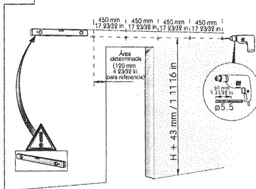
**2A** Para instalación en albañilería
