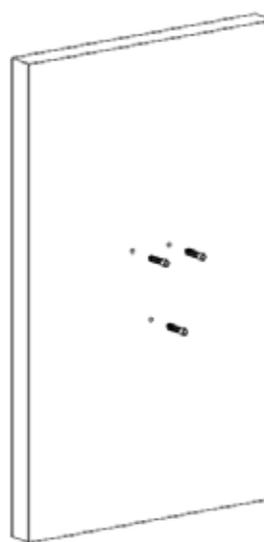
4.1.2 Introduce el taquete de expansión de plástico en el orificio
